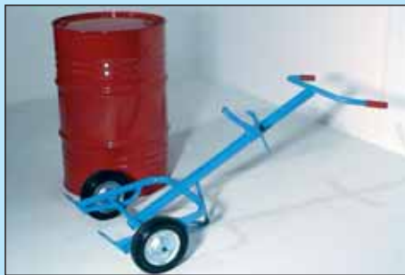
Fasskarre ohne Stützrad, Vollgummiräder Ø 250 mm, Größe: 660 x 1600 mm, Ausführung: Lackiert RAL 5015 Traglast: 400 kg Art.-Nr. 1029-1
