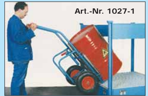
Fass-Transportkarre mit Lufrädern Ø 400 mm und mit 4 Zwillingen-Fassrollen Ø 50 mm • Transport von Stahlfässern • Absetzen auf Lagerpaletten bis max. 400 mm hoch • Als Abfüllbock geeignet • Ausführung: Lackiert RAL 5015
